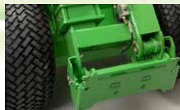
Sistema hidráulico de acoplamiento de accesorios
